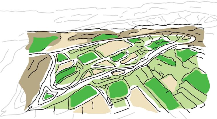
Le site regroupe plusieurs unités (UP3-A et UP2-800) réalisant des opérations différentes : entreposage\* des assemblages de combustibles usés\* ; cisailage et dissolution de ces assemblages ; séparation chimique des produits de fission\*, de l'uranium et du plutonium composant les combustibles ; purification de l'uranium et du plutonium ; traitement\* des effluents ; conditionnement\* des déchets.
